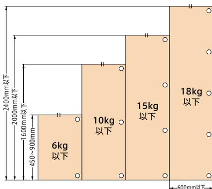
ダンパー内蔵タイプとキャッチ付タイプの併用目安
